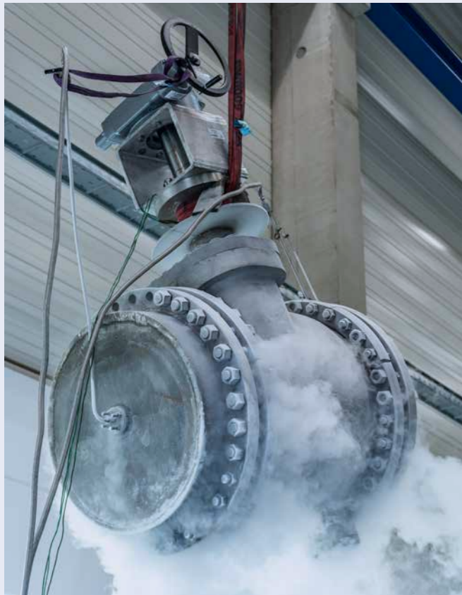
→ Kälteresistente Absperrklappen und Regelklappen arbeiten dank OHL Know-how betriebssicher bis -196^{\circ} .
