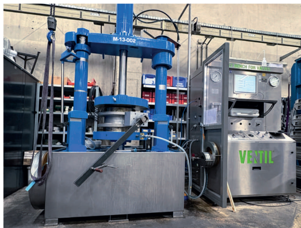
Prüfstand Luftprüfungen: DN 25 - DN 600 und Flüssigkeitsprüfsystem bis 400 bar
